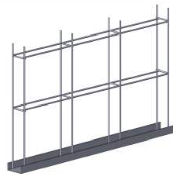
Пример исполнения арматурной закладки
